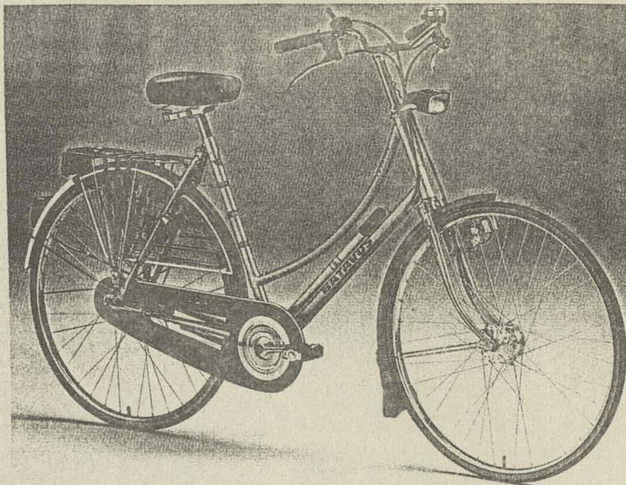
ermöglicht. Die schmalen Edelstahlfelgen (32 mm) garantieren leichten Lauf. Die weiteren Daten: gekapselte FAG-Tretlager-Einheit, 3-Gang-Schaltung F&S, Sachs-Trommelbremse, verstellbarer Lenker, Scheinwerfer mit Reservebirne, diebstahlsicheres Basta-Rahmenschloß. Kunststoff-Kettenkasten, stabiler Stahlgepäckträger.
