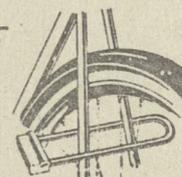
SPEICHENSCHLÖSSER sitzen an der Hinterradgabel. Das Fahrrad wird abgeschlossen, indem man einen Schubriegel zwischen die Speichen schiebt. Es gibt praktisch kein Speichenschloß, das nicht innerhalb weniger Sekunden ohne jedes Werkzeug aufgebrochen werden kann - und sei es, man tritt einmal kräftig dagegen. Dieses Schloß gehört zur deutschen Fahrradstandardausrüstung und ist als Sicherung völlig indiskutabel.
