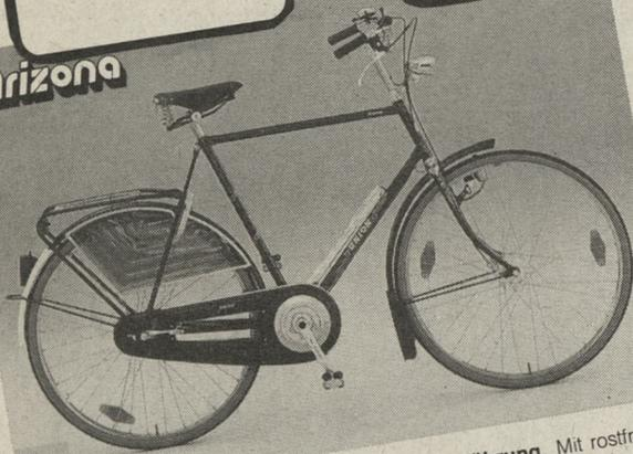
**ARIZONA Ein Holland-Sportrad in Luxus-Ausführung.** Mit rostfreien Edelstahlfelgen, Rillenkugellager mit keillosem Aero Coronado Tretlager, Brooks Ledersattel, Halogen Beleuchtung und Sicherheitsschloss. Lieferbar mit Torpedo-Bremsnabe, Dreigang-Torpedo-Bremsnabe oder F & S VR-Trommelbremse mit
