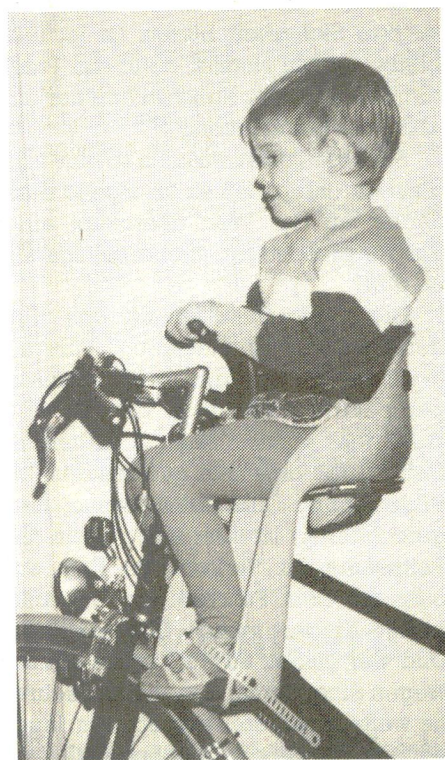
Foto 2: Kinderbeine außerhalb der Beinschale bei zu kurzen Fußstützen
