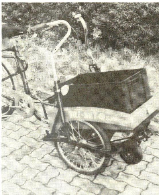
Links: Hinterbau des Tri Sets. Deutlich sind die nach hinten offenen Rohre zu sehen, auf die die Gepäckbehälter aufgesteckt werden können.
