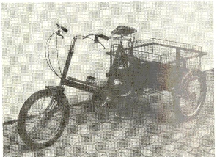
Auf der Ebene bei mäßigen Geschwindigkeiten bringt die Bremsanlage (vorne SA Trommelbremse 80 mm Durchmesser, hinten 2 Seitenzugfelgenbremsen auf Stahlfelgen, von einem Bremshebel mit Doppelbremszug bedienbar) das Fahrzeug zum Stehen, bei extremeren Situationen (Nässe, Gefälle) dürfte es Schwierigkeiten geben. Besonders die hinteren Felgen sind dann kaum wirkungsvoll. Eine Lichtanlage - typisch britisch - fehlt. Das "Middleweight" ist in der Dreigangausführung für 2.345,- DM zu haben.
