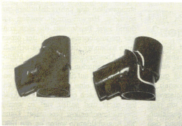
Ermüdungsbrüche im Steuerkopfbereich durch die Prüfung (links) und in der Praxis (rechts)
