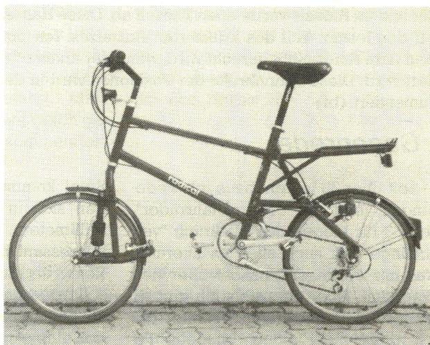
DICALs dadurch entgegengetreten, daß sie die Federungselemente (Vorder- und Hinterradelement sind im Prinzip gleich) als offene Systeme konzipiert haben, deren Verschleißteile keine Spezialanfertigungen, sondern Industriestandardbauteile sind. Damit könnte - falls doch einmal ein Defekt auftritt - auch der interessierte Laie diese selbständig beheben.
