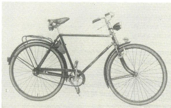
Miele-Tourenrad von 1950. Typisch für diesen Fahrzeugtyp der lange Radstand, der "NSU-Lenker" mit Gestänge-Vorderradbremse, stabilem Gepäckträger aus gebogenem Stahlrohr, Ledersattel mit Doppelspiralfeder, Werkzeugtasche und Firmenemblem auf dem vorderen Schutzblech. Foto aus: J. Franke, Illustrierte Fahrrad-Geschichte, Berlin 1987, S. 135
