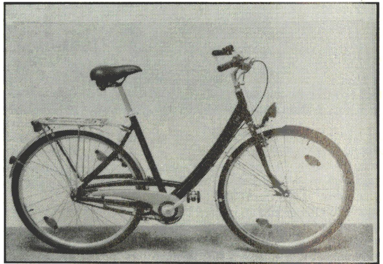
Das Stadtrad S 140 der Fahrradmanufaktur: 28“-Laufräder, Einrohrrahmen mit Tragegriff (garantiert tiefen Durchstieg und Flexibilität), 7-Gang-Nabenschaltung mit Rücktrittbremse
