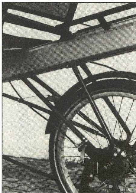
Heck des Oké-Ja mit Hinterbaumodul (unten) und Sitz-Gepäckträger-Modul (oben).
