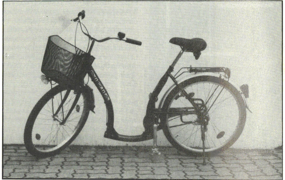
Der Achsständer steht steil, das Vorderrad ist stark eingeschlagen. Bereits bei geringer Zuladung in den Korb (serienmäßig) kippt das Rad um.
