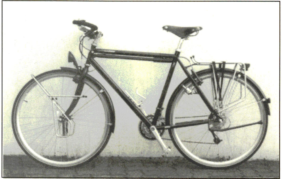
Das „T 900“. Hinten Gepäckträger für seitliche Taschen, vorne Low-Rider serienmäßig. Im Rahmen-dreieck zwei Flaschenhalter. Clipless-Pedale mit zwei unterschiedlichen Seiten für Normalschuhe oder Shimano Trekkingschuhe.
