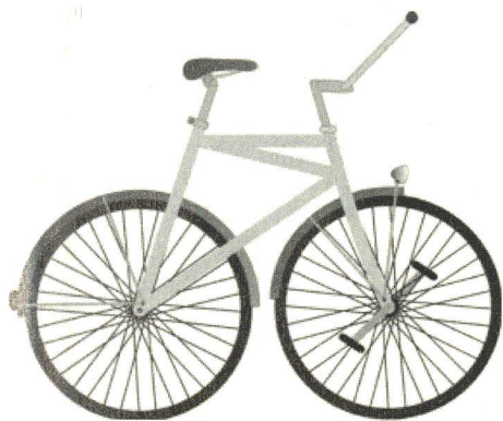
„shortbike“ Rad mit extrem kurzen Radstand für spezielle Verwendungen
