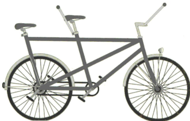
Tandem Vorne „Normalantrieb“, hinten „direct-drive-Nabe“, dadurch kaum länger als ein normales Fahrrad
