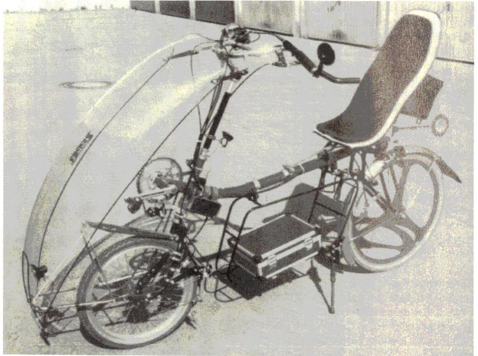
**Abb. 1: Bevo-Bike nach dem Umbau.**
