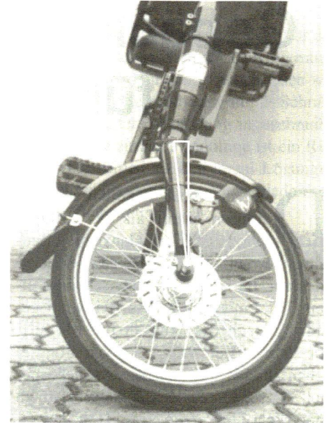
Bild 14: Rahmenanhebung durch die Schräglagestellung beim Kuvenfahren.
