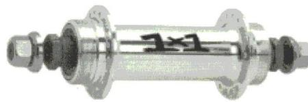
**Abb. 3: Singlespeednabe mit Freilaufgewinden an beiden Seiten**
