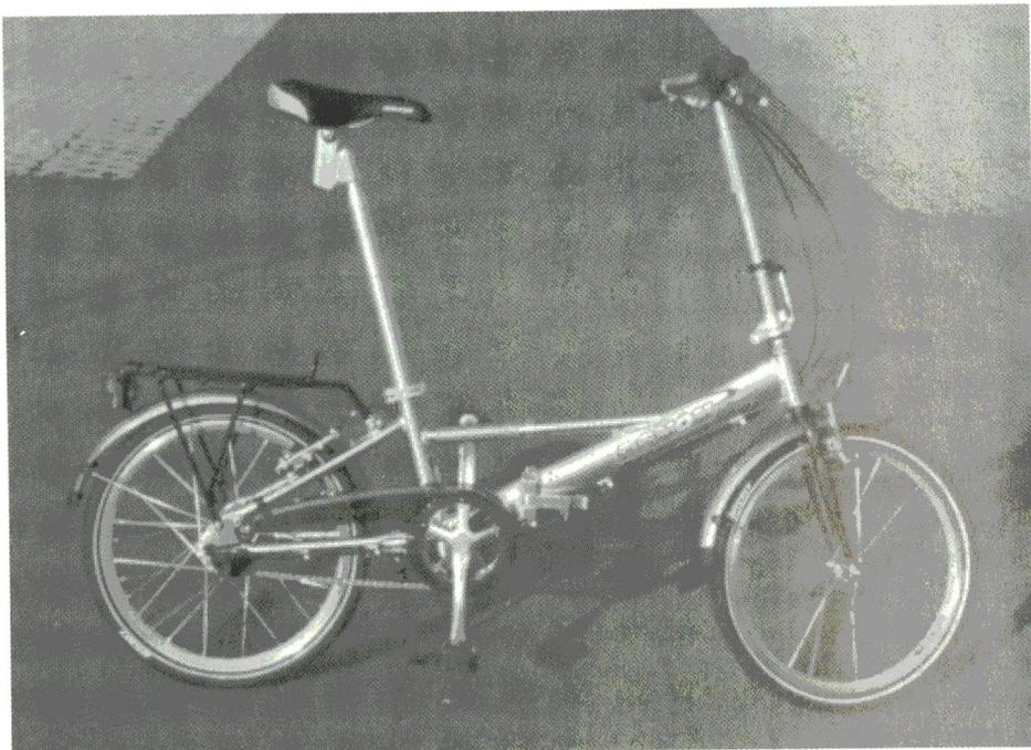
Das „Helios LE“ fährt sich gut. Natürlich können sich seine Fahreigenschaften bauartbedingt nicht mit denen eines großen Velos messen. Allein schon deshalb, weil die kleinen 20 Zoll Räder jeder Spur- rille nachlaufen. Aber auf ebener Fahrbahn macht das Fahren mit dem „Helios“ Spaß. Und dank der Fünfgangnabe „Spectro P5“ von SRAM (einst bekannt als Sachs „Penta- sport“) kommt man überraschend schnell voran. Gebremst wird mit zwei V-Brem- sen.
