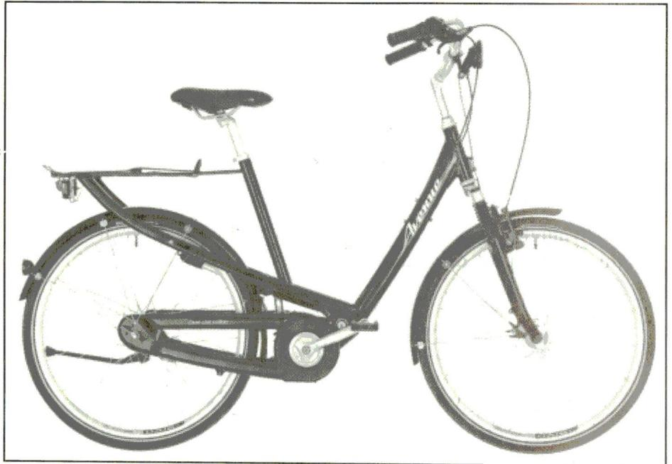
**Konzept:** Das Avenue black ist ein vollgefedertes City-Bike mit tiefem Durchstieg und wartungsarmen Antrieb. Die Kette verläuft schmutzgeschützt in den Rohren der Hinterradschwinge.
